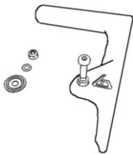
1.d – Place un joint torique sur la vis de 20mm, et mets les dans le trou de la crosse (côté logo).
